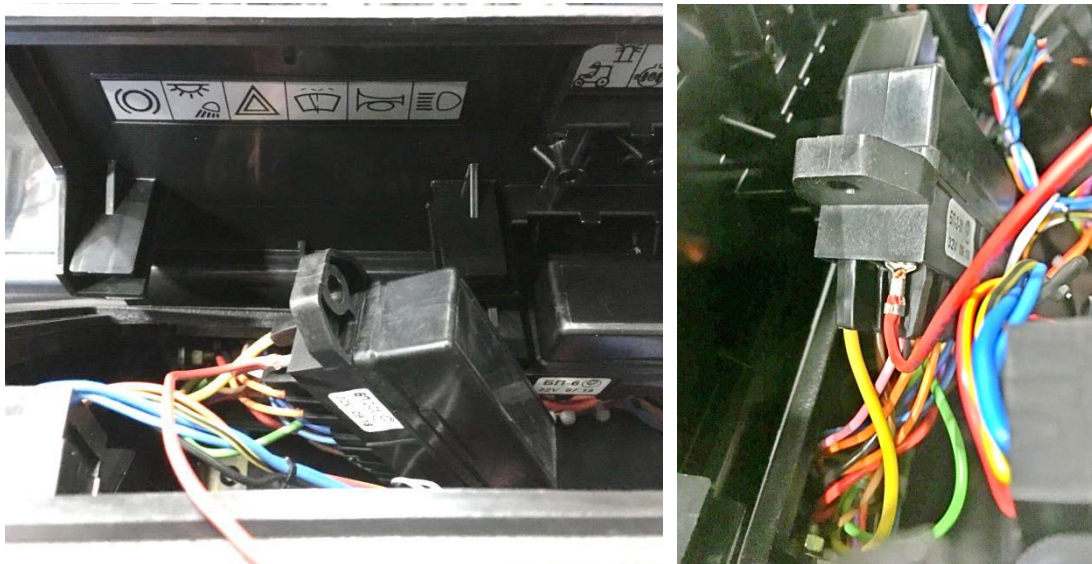
Рис. 4.3.24 – Подключение жгута кабины к питанию
